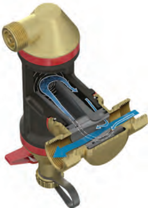
Комбинированный сепаратор воздуха и грязи Flamcovent Clean Smart в разрезе. Принцип работы.
