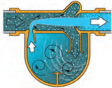
Сепаратор воздуха Flamcovent Smart в разрезе. Принцип работы.
