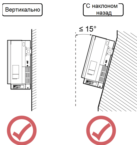
Рис. 4-3 Правильные углы установки
