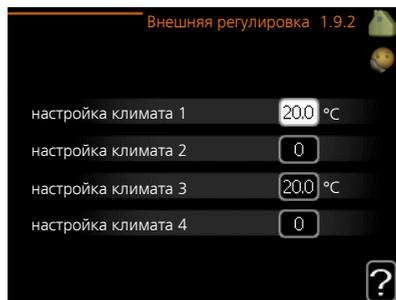
Подключение внешнего контакта (например, комнатного термостата или таймера) позволяет временно или периодически повышать или понижать комнатную температуру во время нагрева. При замыкании кон-
