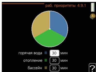
Здесь выбирается длительность работы установки по каждому требованию при одновременном наличии нескольких требований. При наличии только одного требования установка работает только согласно этому требованию.
