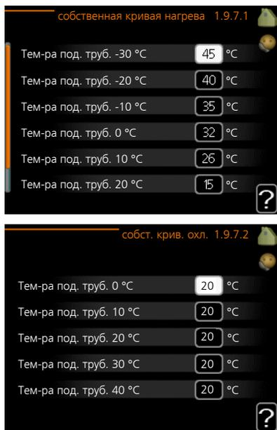
Здесь можно создать собственную кривую нагрева или охлаждения, установив требуемые значения температуры подачи для различных наружных температур.
