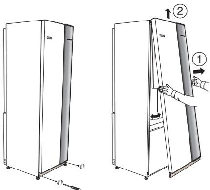
1. Снимите винты с нижнего края передней крышки.
