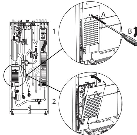
1. Вставьте отвертку (A) и осторожно сдвиньте фиксатор вниз (B).
