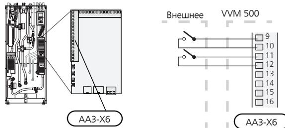
В вышеприведенном примере используются входы AUX1 (X6:9-10) и AUX2 (X6:11-12) на клеммной колодке (AA3).
