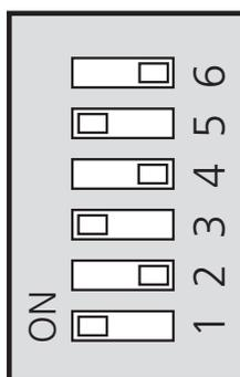
На рисунке изображена заводская установка DIP-переключателя (AA1-SF1), т. е. 6 кВт.
