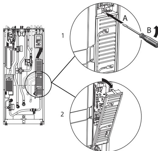
1. Вставьте отвертку (A) и осторожно сдвиньте фиксатор вниз (B).
