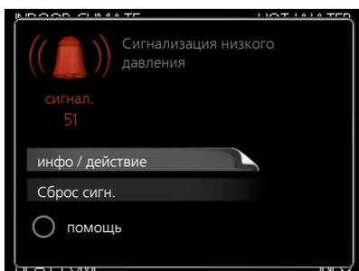
Аварийная сигнализация указывает на сбой того или иного типа, о чем свидетельствует состояние лампы, меняющей цвет с непрерывного зеленого на непрерывный красный. Кроме того, в информационном окне отображается сигнальный колокол.
