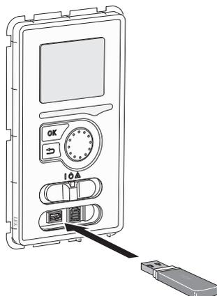
Блок дисплея оснащен USB-разъемом, который можно использовать для обновления программного обеспечения, сохранения зарегистрированных сведений и работы с установками в VVM 500.
