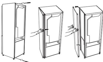
Боковые панели можно снять для облегчения установки.
