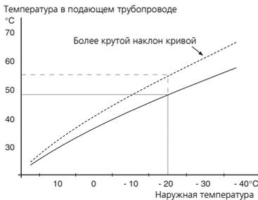
Оптимальный наклон зависит от климатических условий в той или иной местности, наличия в доме радиаторов или подогрева пола и качества теплоизоляции дома.
