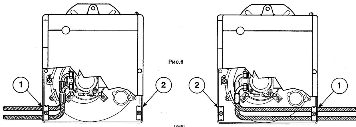
На обеих сторонах корпуса горелки предусмотрены гнезда для топливных шлангов. В зависимости от того, с какой стороны подводятся топливные шланги, ориентируются крепежная планка (1) и запорная накладка (2) (см. рис. 6).
