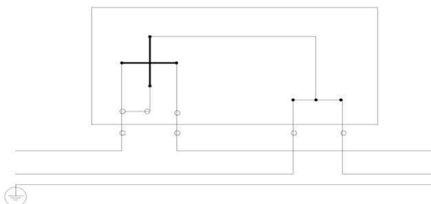
1.3 Необходимо придерживаться маркировки проводов: **коричневый – фаза, синий – ноль** (рис.1.2), **желто-зеленый** провод служит для заземления, он крепится к контуру заземления болтовым или винтовым соединением. После выполнения всех расключений, проверить работу счетчика на предмет учета электроэнергии! Правильность вращения диска в индукционном счетчике или импульсное мигание светодиода в электронном!
